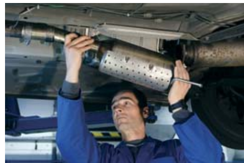
Nachrüstung eines Partikelfilters
