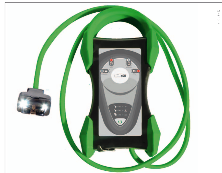
Ab Juli 2015 wird ein spezielles Gerät zur Kommunikation mit dem Fahrzeug, der HU-Adapter 21 plus, von den Prüfern eingesetzt.
