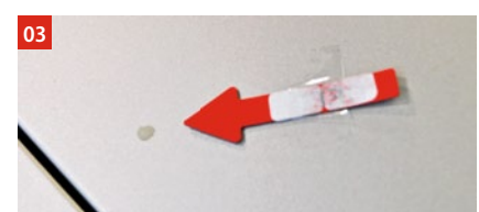
Drei Schäden | Der Lackdichtenmesser zeigt an, dass hier überlackiert wurde (01), der Stoßfänger ist beschädigt und muss berechnet werden (02), die Motorhaube weist Baumharzflecken auf, die ohne Berechnung bleiben (03)
