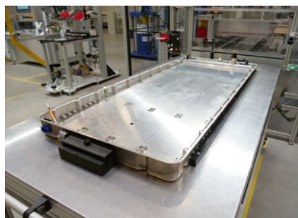
Links zu sehen: die Platte mit den Kühlkanälen. Auf dieser werden die Module montiert. Diese Art der Flüssigkeitskühlung ist äußerst effektiv und ermöglicht eine maximale Nutzung der Batteriemodule. Das mittlere Bild zeigt die Kühlplatte im System, das rechte einen Teil der Modul-Elektronik
