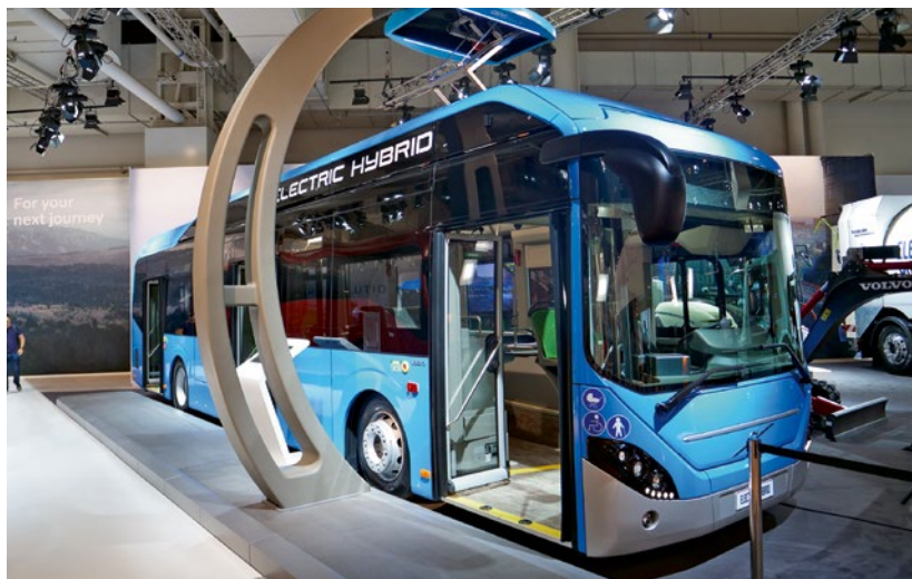
Volvo setzt auf die offene Ladeschnittstelle OppCharge. Vereinheitlichung ist wichtig
