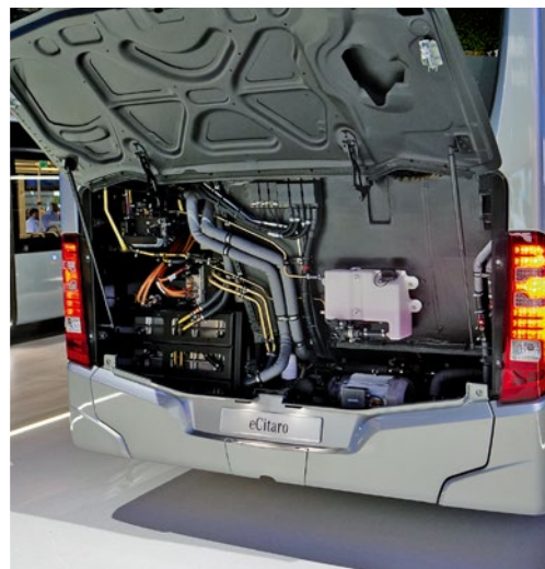
Der eCitaro hat seine Akkus im Heck und auf dem Dach
