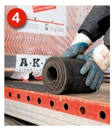
Antirutschmatten erhöhen den Gleitreibbeiwert. Dabei muss die Matte so ausliegen, dass die Ladung keinen Kontakt zur Ladefläche hat.
