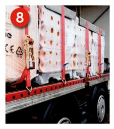
Zweite Variante: Durch die Antirutschmatten erhöht sich der Gleitreibbeiwert  $\mu = 0.6$ . Es reicht ein Niederzurren mit einem Gurt je Palette.
