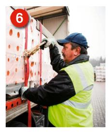
Kraftschluss: Durch das Niederzurren (Ladegut muss formstabil sein) wird die Reibungskraft zwischen Ladung und Ladefläche erhöht.
