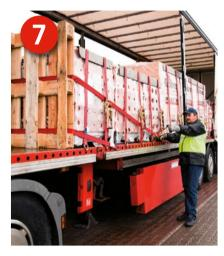
Formschluss: Es liegen keine Matten aus und der Gleitreibbeiwert ist unbekannt. Daher wird in diesem Fall die Ladung zusätzlich direktverzurrt.
