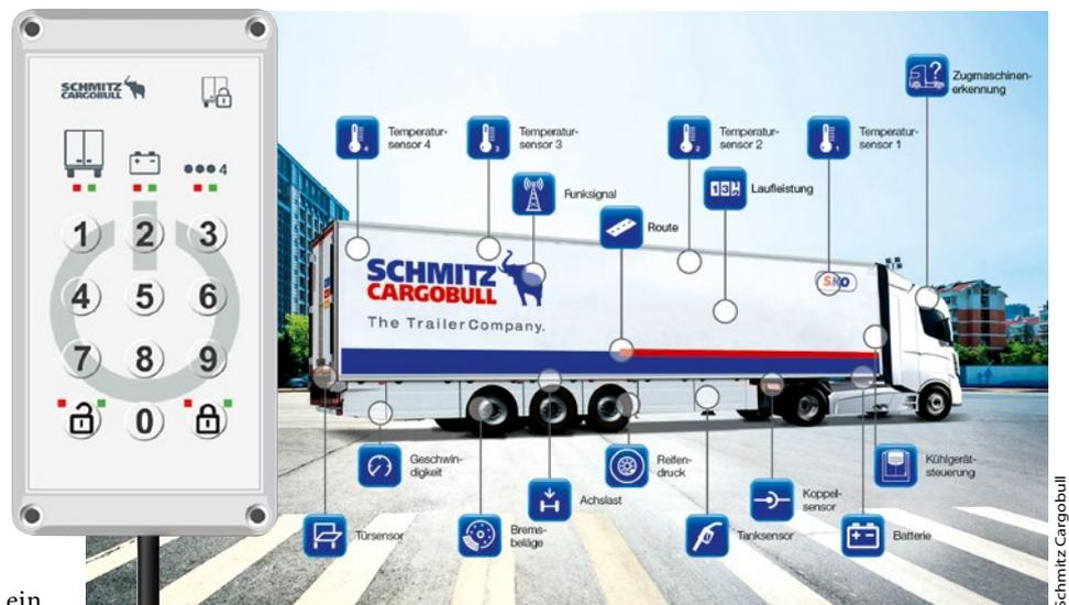
Das Key Pad TL3 zum Öffnen und Verschießen der Hecktür
