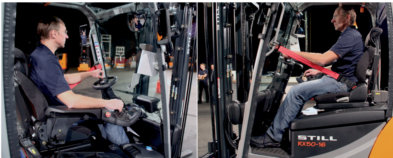
Die Armlehne mit den von den Testern bevorzugten Minihebeln (links). Das spezielle Sicherheitsgurtsystem (rechts) scheuert am Unterarm
