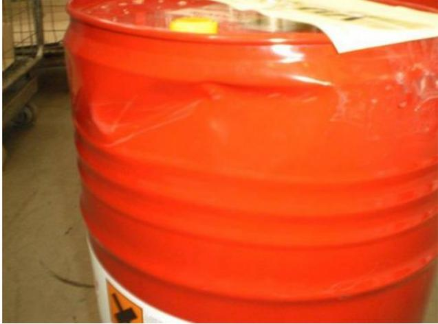
A red metal drum with a visible scratch on its side.                 | Leichte Beschädigung, Weitertransport zulässig.   |
