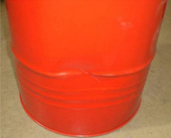
A red metal drum with a visible dent on its side.                      | Leichte Beschädigung, kein Transportverbot        |
