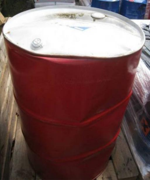
A red metal drum with a white top, showing a dent on the top surface. | Leichte, weiche Dellen, Weitertransport zulässig. |
