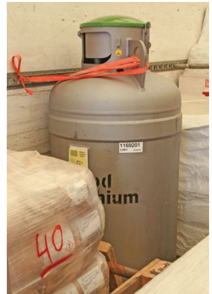
Krasses Mängelbeispiel: Ein Behälter mit einem Klasse-4.3-Stoff in Beförderungskategorie 0, nur mit dünnem Gurt und Knoten gesichert.
