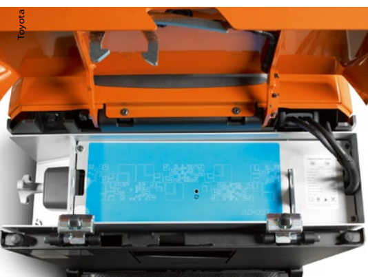
Fest verbaute Li-Ionen-Batterien wie im Niederhub-Kommissionierer „BT Optio“ von Toyota ermöglichen kompaktere Fahrzeugdesigns
