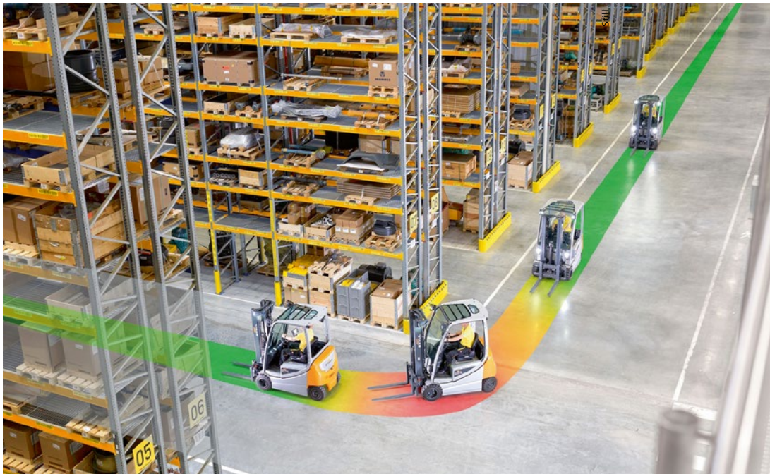
Assistenzfunktionen wie „Curve Speed Control“ von Still passen die Geschwindigkeit dem Lenkwinkel an
