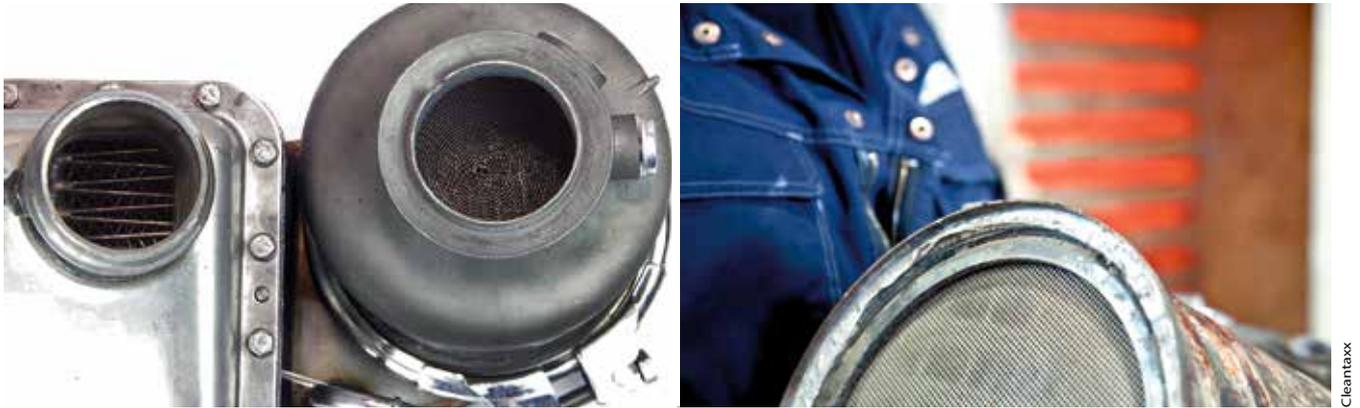
Bei Dieselstaplern muss der Rußpartikelfilter freigebrannt werden. Reinigungslösungen für alle Stapler-Modelle bietet beispielsweise Cleantaxx an
