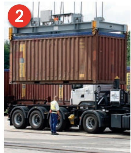
„Huckepackverkehr mit Wechselbehälter (1) oder Container (2)“: Spezielle LKW und Anhänger oder spezielle Sattelanhänger übernehmen die An- und Abfahrt zum und vom Verladeterminale. Der überwiegende Teil des Transportes (Hauptlauf) findet auf der Schiene statt.
