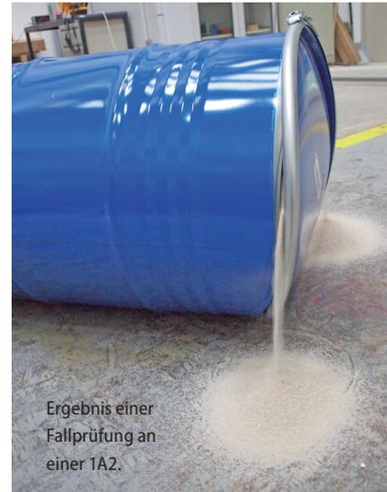
Ergebnis einer Fallprüfung an einer 1A2.
