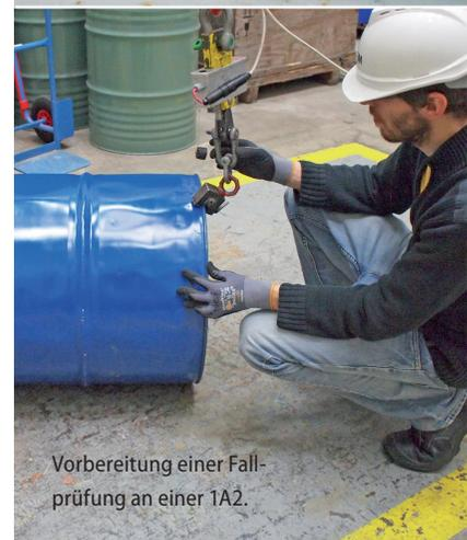
Vorbereitung einer Fallprüfung an einer 1A2.
