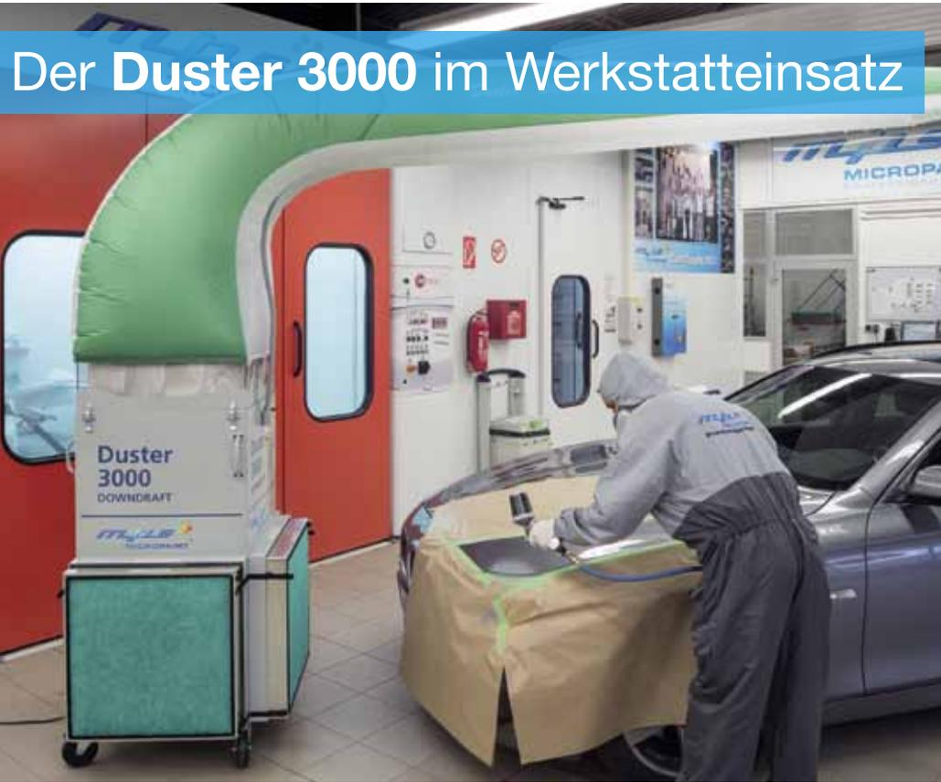
Durch das Umluftsystem geht keine Wärme in der Werkstatt verloren. Diese Tatsache wurde auch auf der Automechanika 2010 mit der Aufnahme ins „Green Directory“ gewürdigt. Staub und Farbnebel werden über das 4-fach Filtersystem angesaugt und sehr effektiv gereinigt, es bleibt nur reine Luft.
