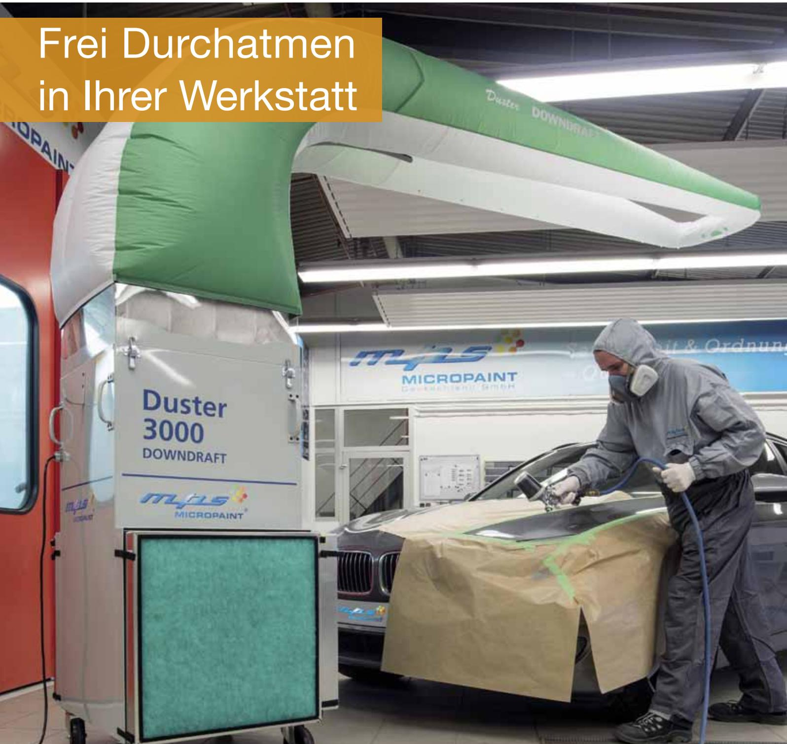
Die mobile und energiesparende Umluftabsauganlage sorgt für eine gereinigte Luft in Ihrer Werkstatt. Ob beim Schleifen, Füllern oder Lackieren – der **Duster 3000** verbessert die Atemluft an Ihrem Arbeitsplatz indem er den Staub und die Lösungsmittel in Ihrer Umgebung in fast reine Luft umwandelt. In ausgeschaltetem Zustand benötigt der Duster 3000 nur etwa 1 m<sup>2</sup> Platz.
