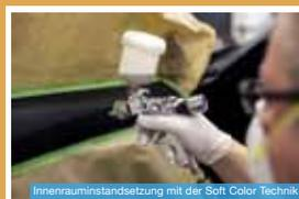
Innenraum-Instandsetzung mit der Soft Color Technik
