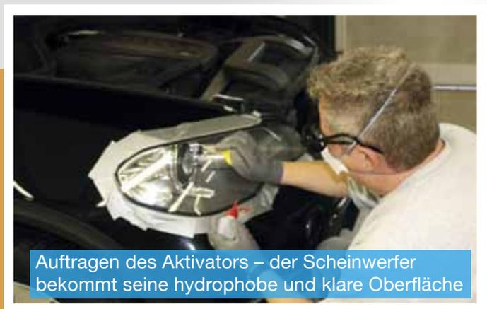
Auftragen des Aktivators – der Scheinwerfer bekommt seine hydrophobe und klare Oberfläche
