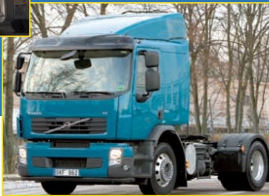
Der FE340 ist Volvos leichtester Beitrag – er wiegt knapp unter 6,1 Tonnen.
