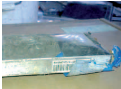
Sekundärer Lithiumblock mit „Bauch“.
