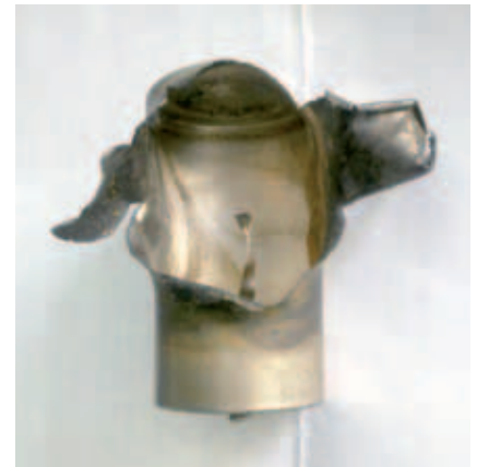
Ausgebrannte primäre Lithiumbatterie.
