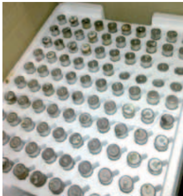
Primäre Lithiumbatterien: Rostansatz und Austritt von Batterieinhalt, vorwiegend bedingt durch Elektroflüssigkeit.
