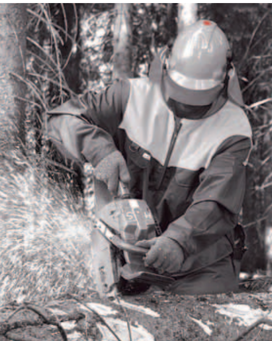
Für den Schnittschutz von Waldarbeiter-Schutzanzügen sorgen eingearbeitete Polyamidgewebe, die eine mechanische Blockierung der Kettensäge bewirken.
