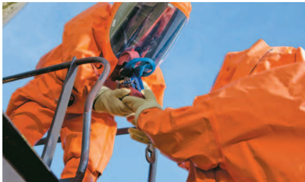
Eine Materialkombination aus robuster Elastomerschicht, chemisch beständiger Laminatschicht und reißfestem Textil macht den Dräger Chemikalienschutzanzug CPS 7900 chemikalienbeständig, flammenhemmend, selbstverlöschend, antistatisch, bei Kälte flexibel und widerstandsfähig gegenüber schwerer mechanischer Beanspruchung.
