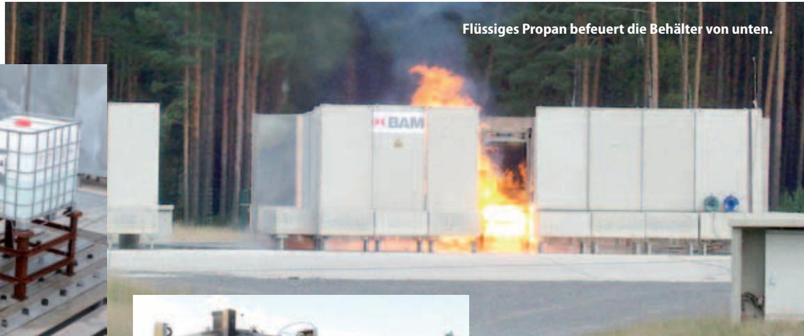
Flüssiges Propan befeuert die Behälter von unten.
