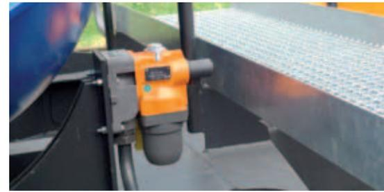
Jeder Waggon ist mit zwei mechanischen Entgleisungsdetektoren ausgerüstet.
