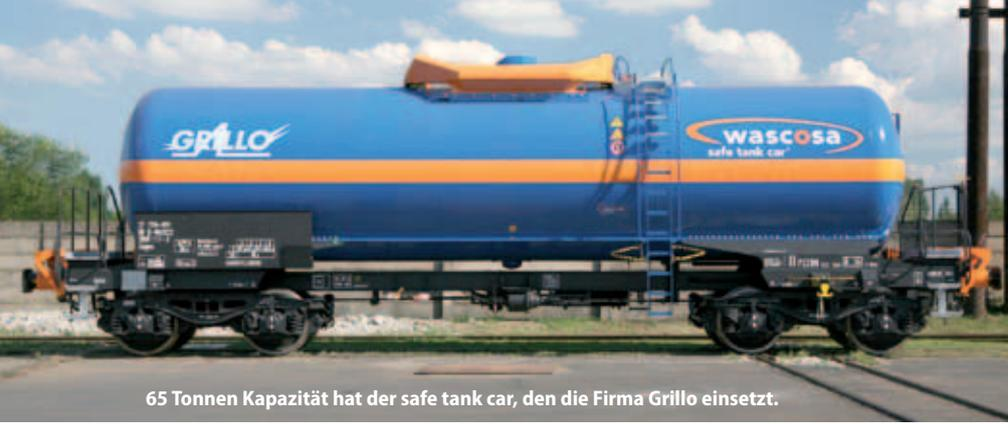
65 Tonnen Kapazität hat der safe tank car, den die Firma Grillo einsetzt.
