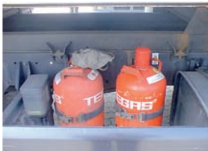
Gasflaschen für die Standheizung sind nach dem ADR freigestellt.
