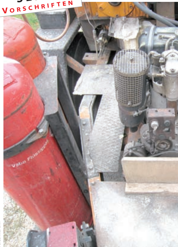
Gasflaschen für Bitumenkocher können während der Fahrt betrieben werden.
