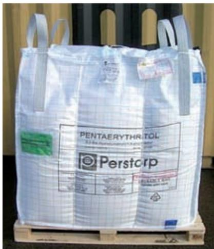
Der neue FIBC-Typ Dplus für den Einsatz bei elektrostatischen Ladungen. Er vermeidet durch seine Erdungsfähigkeit die Nachteile des Typ C und des herkömmlichen Typ D.
