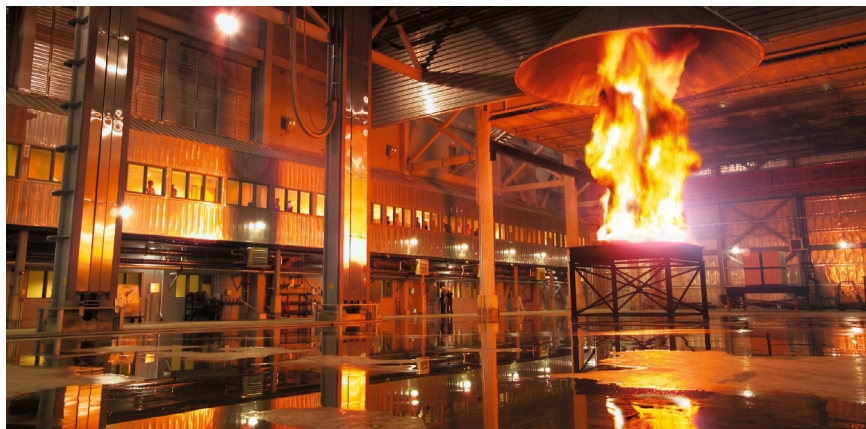
Versuche des Industrierversicherers FM Global zu Brandrisiken bei Lithium-Ionen-Akkumulatoren zeigen, wie wichtig eine frühzeitige Löschung und Kühlung ist.
