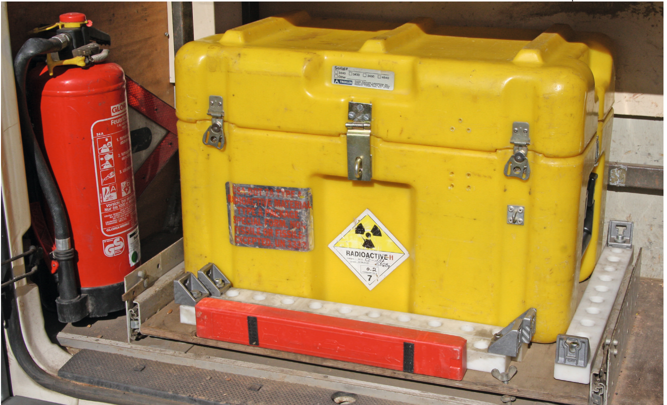
Ladungssicherung: Das Typ-A-Versandstück wird im Fahrzeug in einer Vorrichtung mit Distanzstücken fixiert.
