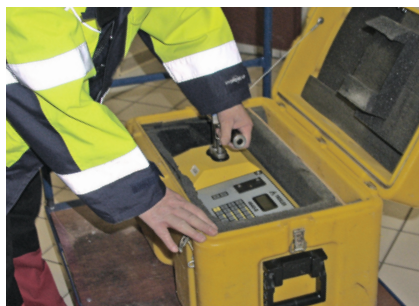
Typ-A-Verpackung mit Troxler-Sonde. Der Fahrer muss eine ADR-Schulung mit Basiskurs und Aufbaukurs Klasse 7 absolvieren.
