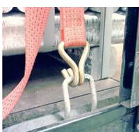
**ZURRPFUNKTE/ZURRÖSEN** sind in festen Abständen am Fahrzeugrahmen angebracht. Der maximale Abstand zwischen den Ösen ist mit 1,20 Meter festgelegt.
