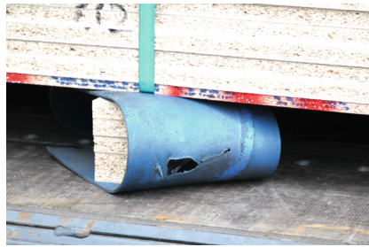
Untaugliches Material: bleibende Verformungen, Risse, Löcher, starke Verschmutzung.
