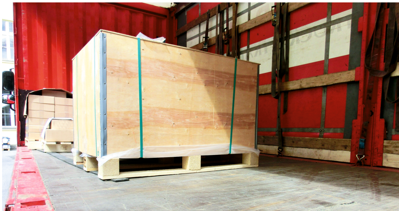
Leider weit verbreitet: Rutschhemmendes Material zur Sicherung wird nur auf der linken Seite eingesetzt, der so genannten „Polizeiseite“.
