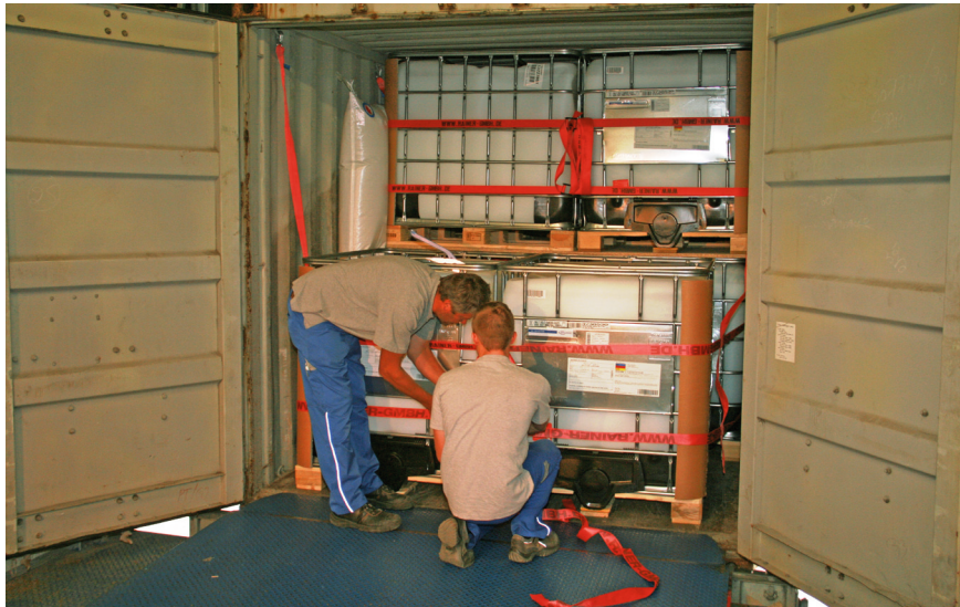
Schlusslashing mit Gurten und Kantenschonern. Zwischenräume sind mit Staupolstern gefüllt.
