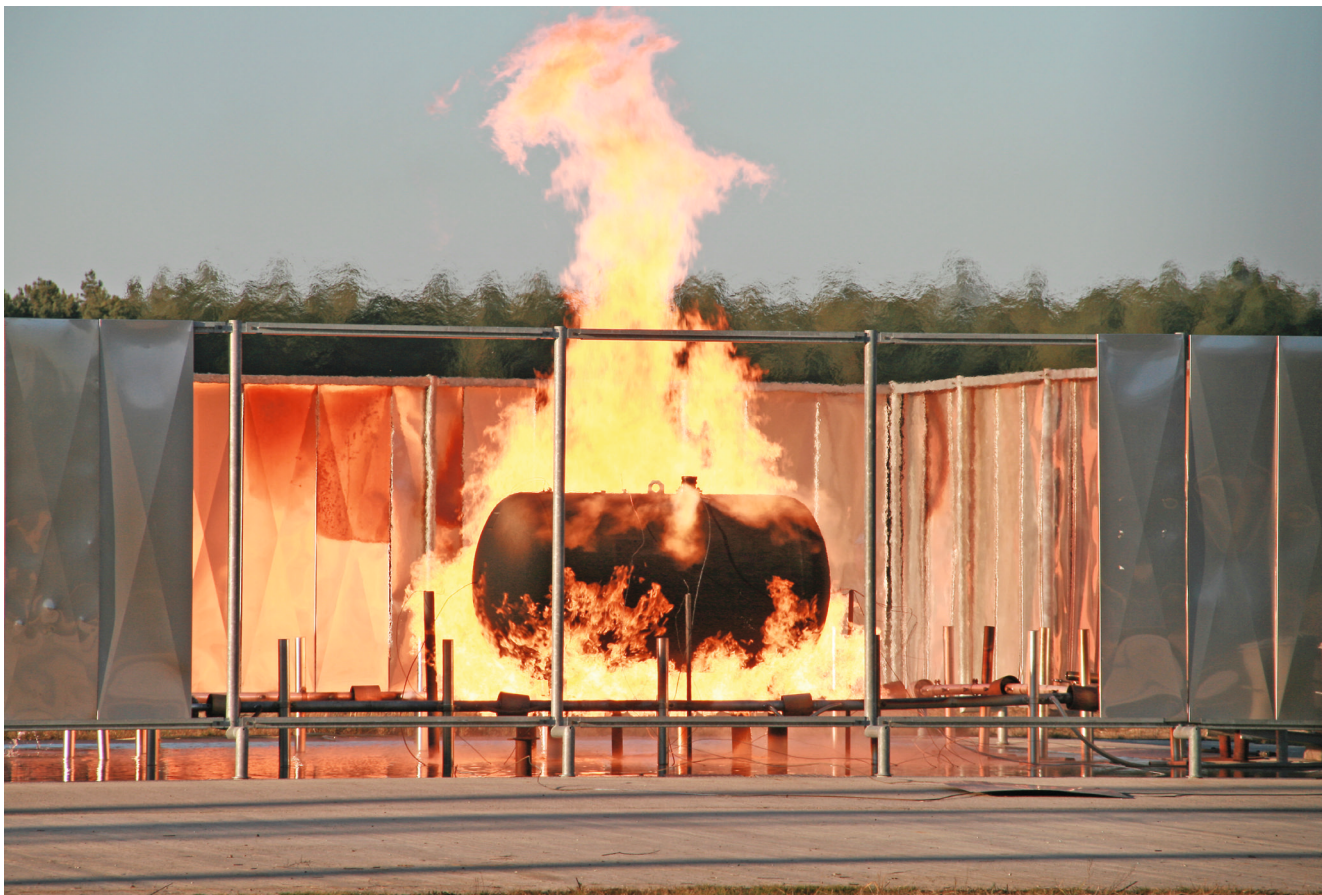
Oben: Brandversuch auf dem BAM-Testgelände Horstwalde. Durch das Ventil auf der Oberseite des Tanks entweicht das Gas, der Innendruck wird abgebaut. Rechts: Kein Feuerwerk, sondern Aerosoldosen unter Einwirkung von Feuer.
