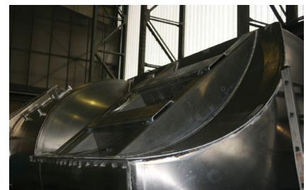
Das Patent Ellinghaus ist einzigartig, der Tank liegt waagrecht. Der Auflieger für den Königszapfen wird in den Tank integriert.
