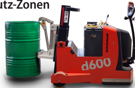
Das obere Greifelement hakt sich am Fassrand ein, sobald der Mast geneigt wird.
