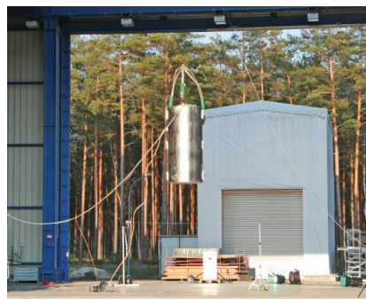
Sicher beim Fall aus neun Metern Höhe: Umverpackung Daher-NCS DN 30 für UF 6 -Zylinder.
