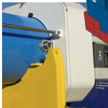
Tragzapfen (li.: Realität, o.: Finite-Element-Modell), BAM-GGR 012.
