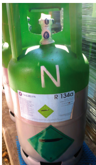
Ein ergänzender Gefahrzettel in der Regelgröße 10x10 cm musste zusätzlich angebracht werden (siehe Bild rechts).
