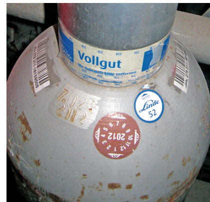
Hier ist die nächste wiederkehrende Prüfung zwar gekennzeichnet, aber die Frist ist abgelaufen. Der Transport ist unter den Bedingungen nach Unterabschnitt 4.6.1.10 noch möglich, wenn im Beförderungspapier ein Zusatzeintrag erfolgt: „Beförderung nach Unterabschnitt 4.6.1.10“
