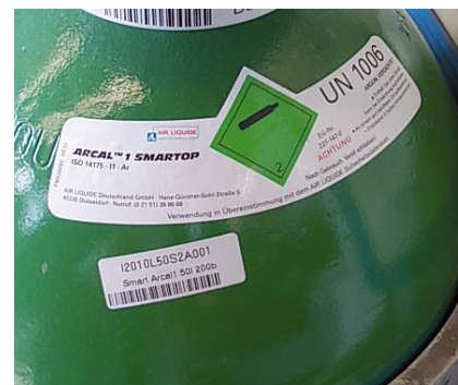
Hier ist alles richtig gekennzeichnet: UN 1006, Argon, verdichtet.
