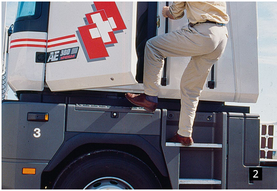
1. Der AE setzte Maßstäbe durch ebenen Boden 2. Umstritten: der „Lokomotiven“-Einstieg
