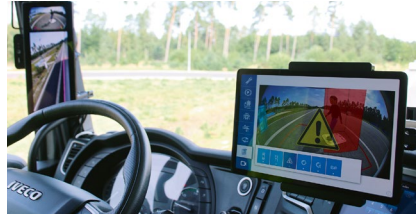
Die Kamera am Trailerheck kann Leben retten, dank 360-Grad-Rundumsicht
