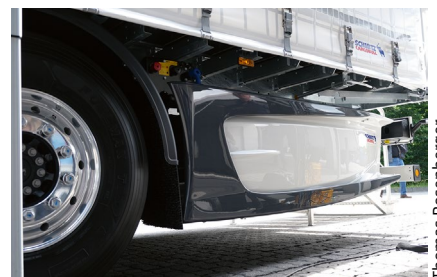
Aerodynamisch und geräumig: EcoBox soll Luftwirbel am Heck vermeiden
