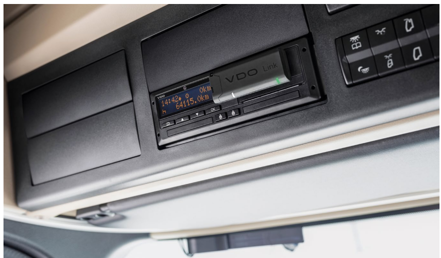
Einfach in die Frontschnittstelle des Tachographen einstecken: Plug-&Play-Lösung zur Verknüpfung des digitalen Tachographen mit cloudbasierten Diensten
