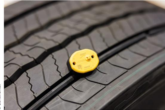
Sensoren von Continental überwachen die Profiltiefe des Reifens automatisch, um präzise Serviceplanungen zu ermöglichen
