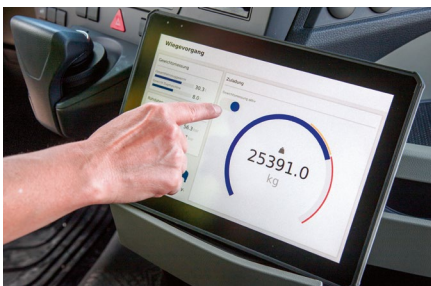
Onboard-Wiegefunktion über das Tablet. Neu: weitere Funktionen für Kippfahrzeuge
