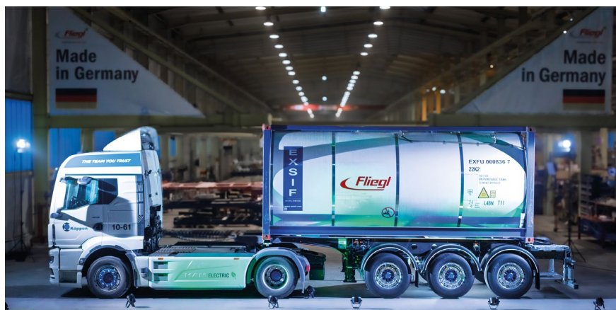
Optimierter Radabstand für mehr Effizienz und Wirtschaftlichkeit bei Nutzung mit E-Lkw
