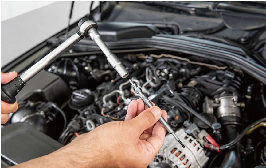
Beim Einbau einer neuen Glühkerze sollte das empfohlene Drehmoment beachtet werden
