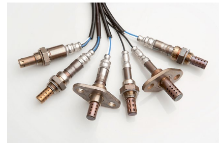
Die Lambdasonde misst den Sauerstoffgehalt im Abgas, um das Gemisch zu optimieren
